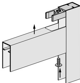
So kann z.B. das Plissee problemlos zwischen Tür und Rollladenführungsschiene montiert werden (Platzbedarf 23 mm).
