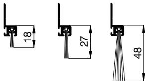
Über ein Langloch kann das h-Profil bis zu 7,5 mm ausgeglichen werden.
