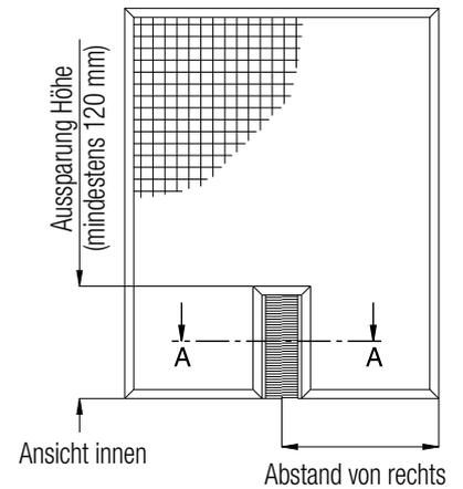
Die Aussparungen für die automatischen Fensteröffner werden über ein h-Profil mit Streifenbürste abgedichtet. Es stehen dabei 2 verschiedene Grössen zur Verfügung.
