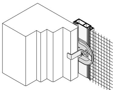
Für eng anliegende Rolladenführungsschienen kann der Spannrahmen um 6 mm eingerückt werden.
